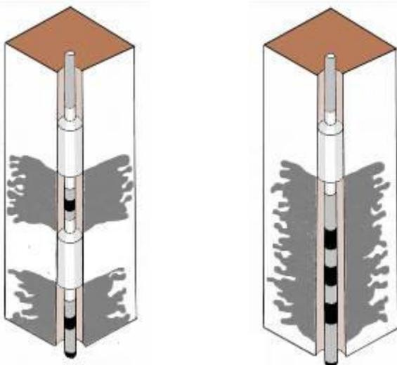
Su instalación es sencilla. Montaremos cada saco obturador sobre el tubo haciéndolo coincidir sobre una válvula que utilizaremos para su llenado. El espacio entre saco y saco nos determinará la zona segmentada a tratar.
