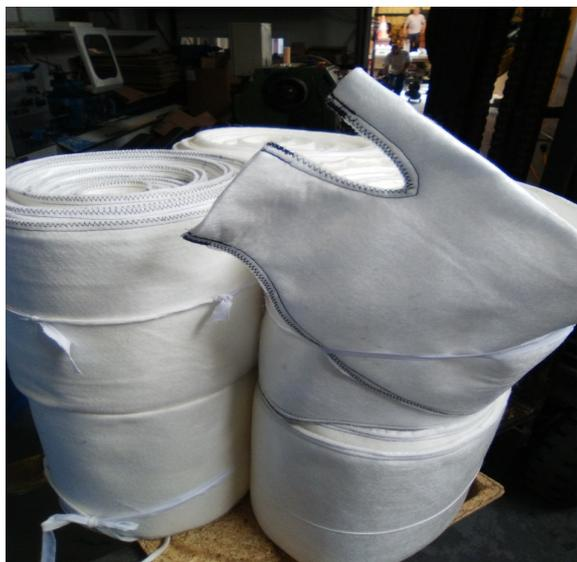
La funda **groutextil** para micropilotes resulta muy útil en aquellas circunstancias en que el terreno imposibilita retener el cemento o lechada.
